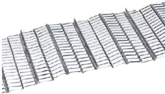
Putzträgerplatte aus verzinktem Stahlblech. Durch enge Maschen wird eine bessere Putzverankerung gewährleistet. Durch die 8mm hohen Rippen sehr robust und widerstandsfähig, trotzdem leicht verformbar. Sehr anpassungsfähig an alle geometrischen Formen.
