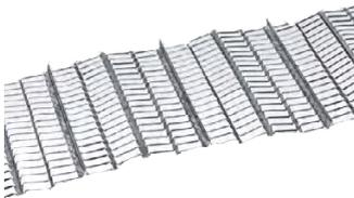
Putzträgerplatte aus verzinktem Stahlblech. Optimal für dünne Putzschichten geeignet. Durch die 4mm hohen Rippen sehr stabil und trotzdem leicht verformbar. Sehr anpassungsfähig an alle geometrischen Formen.
