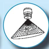
Всичките високопроизводителни пръскачки GLORIA са снабдени с **месингова дюза за плоска струя Тип 8004E**. Ъгълът на разпръзване е 80°. Подходящи са за обработване на повърхности.
